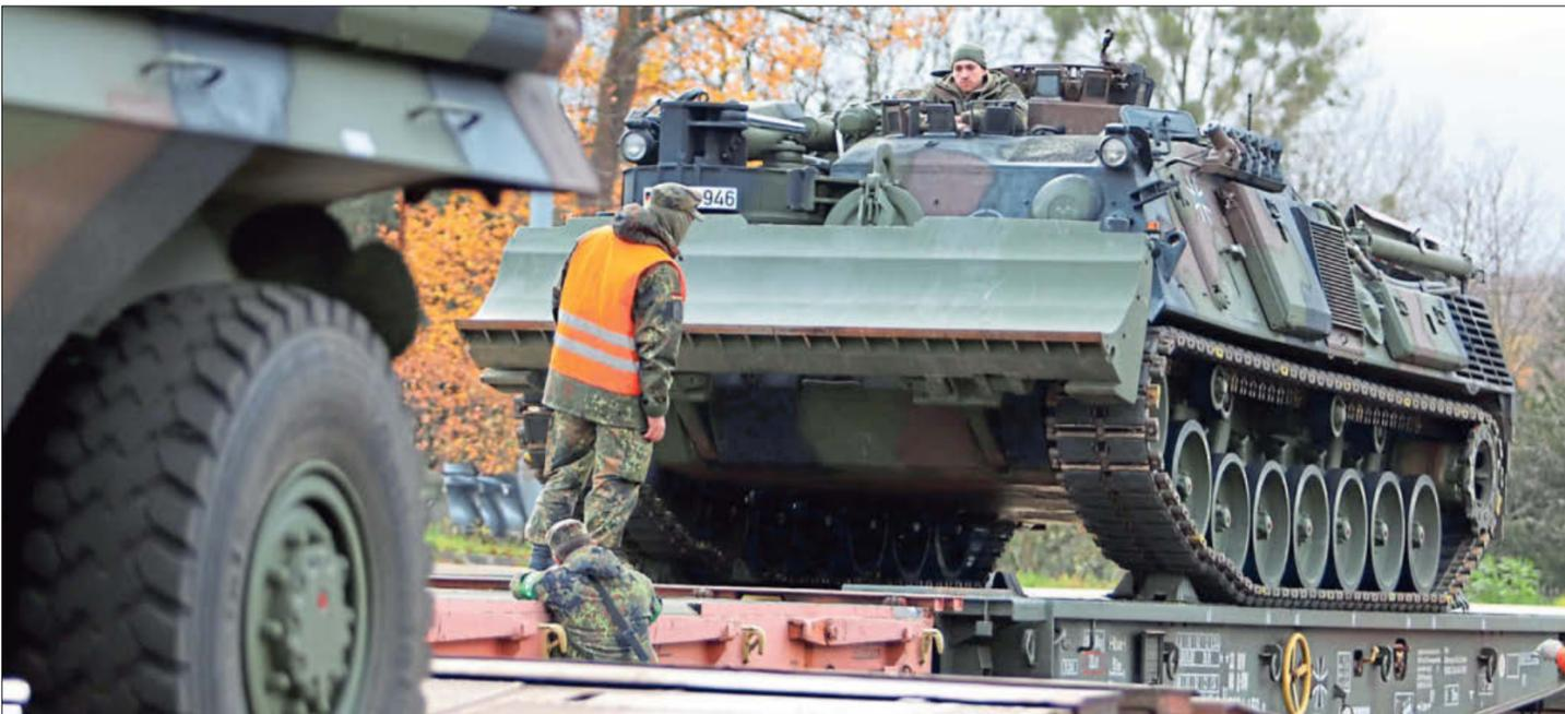
**Minden (mt).** 43 Tonnen wiegt der Pionierpanzer Dachs, mit 3,25 Meter ist er breiter als ein Eisenbahnwaggon. Doch für den Transport über lange Strecken ist der Bahntransport die schnellste Lösung.
