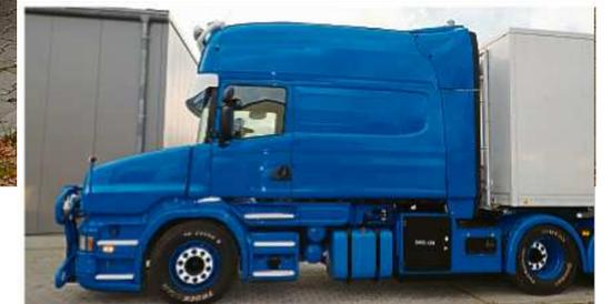
schine T 500, die Harald Bessler komplett überholt und mit einer deutlich verlängerten Kabine ausgestattet hat. Auch der 6-Zylinder-Motor wurde durch einen V8 ausgetauscht. Der TÜV hat mittlerweile sein technisches Okay für das auf 8,40 Meter gestreckte Fahrzeug gegeben, die Bezirksregierung muss jetzt noch den Betrieb genehmigen. Und Bessler ist noch nicht fertig mit den Arbeiten.
