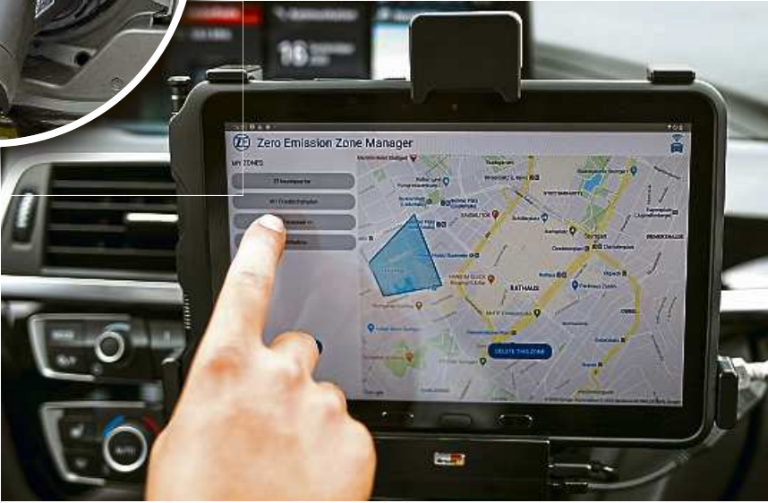
Zonenmanagement: Der Zero Emission Zone Manager von ZF schaltet automatisch in den Elektromodus, sobald das Auto etwa eine Umweltzone oder ein Gebiet mit Null-Emissions-Gebot erreicht.
