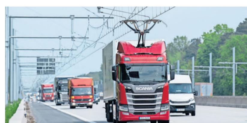
Energiegeladen: Eine Zugmaschine fährt mit ausgefahrenem Stromabnehmer auf dem Teststreckenabschnitt der Autobahn 5.
