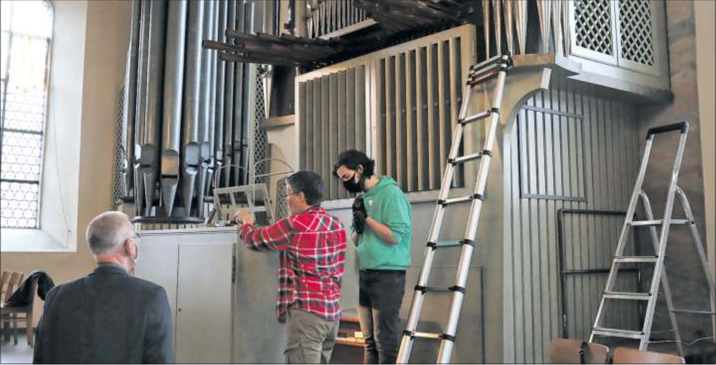
Die großen Pfeifen sind aus schwerem aber weichen Material und tendieren dazu, sich an den Spitzen aufgrund des Gewichts zu verformen.
