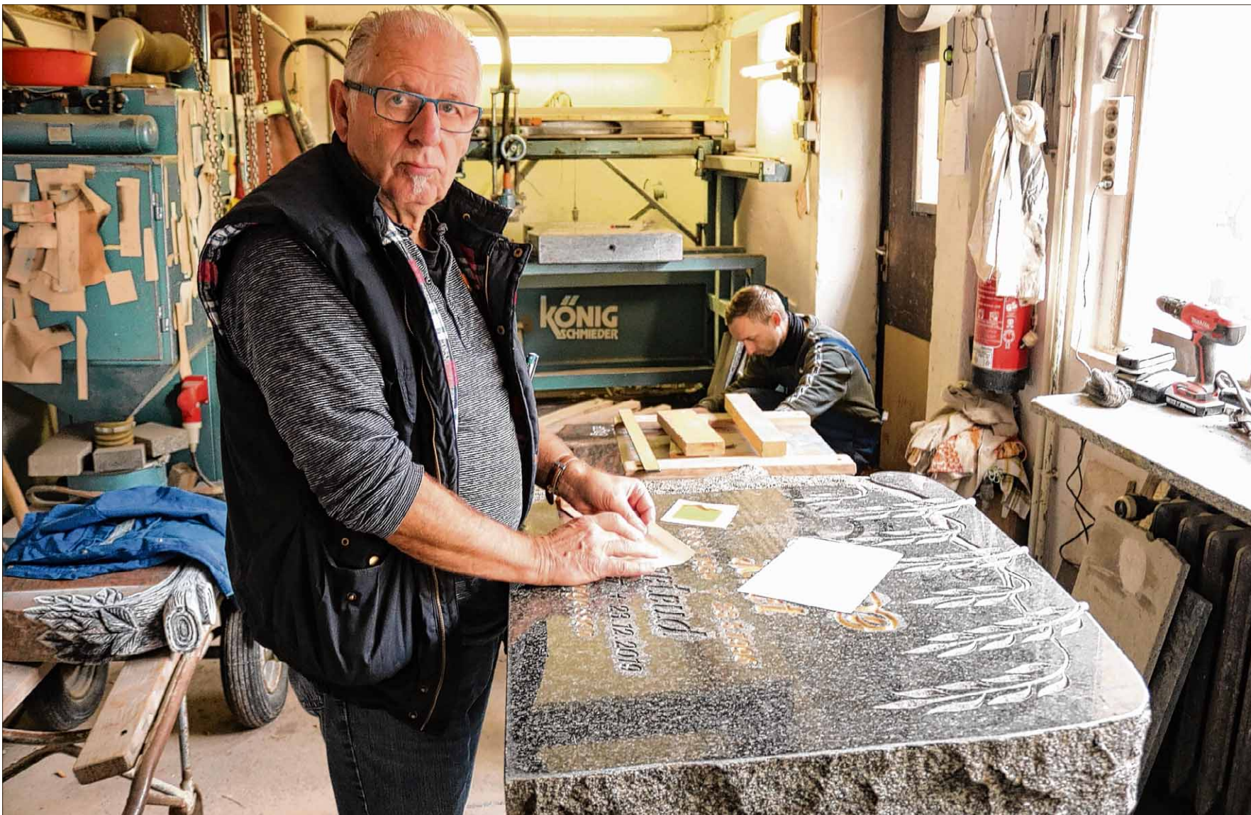
Wingolf Trippler belegt in seiner Werkstatt die Inschrift eines Grabmals mit Blattgold.
