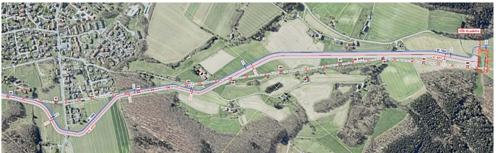
Im weiteren Verlauf in nördlicher Richtung bis zur Übergabestation Klusebrink (rechts) kommt es mehrmals zu Abweichungen von der alten Trasse, da diese fast genau dem Hengbergbach folgt, wo eine Erdverkabelung nicht möglich wäre.
