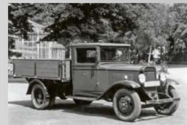
Zwei Grundmodelle mit einer Nutzlast von 1,5 bis zwei Tonnen, drei unterschiedliche Radstände sowie zwei Motoren erfüllen individuelle Kundenwünsche. Schon fünf Jahre nach dem Debüt baut Opel in Brandenburg/Havel eigens ein Werk für die Nutzfahrzeug-Produktion. 1937 verlässt rollt dort bereits der 25 000ste Blitz vom Band. Im selben Jahr erhält der Dreitonner den 3,6-Liter-Sechszylinder des Admirals und ist mit Tempo 90 schneller als mancher Pkw.
