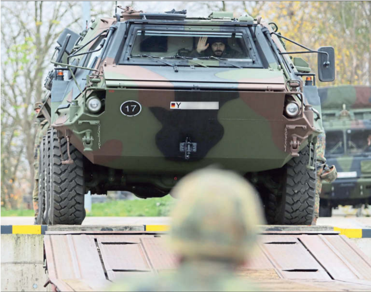
Der Transportpanzer Fuchs hat zwei lenkbare Achsen. Der Fahrer kann nicht genau sehen, ob beide Achsen gerade stehen. Ohne seinen Einweiser ist er aufgeschmissen. MT-Fotos: Alex Lehn
