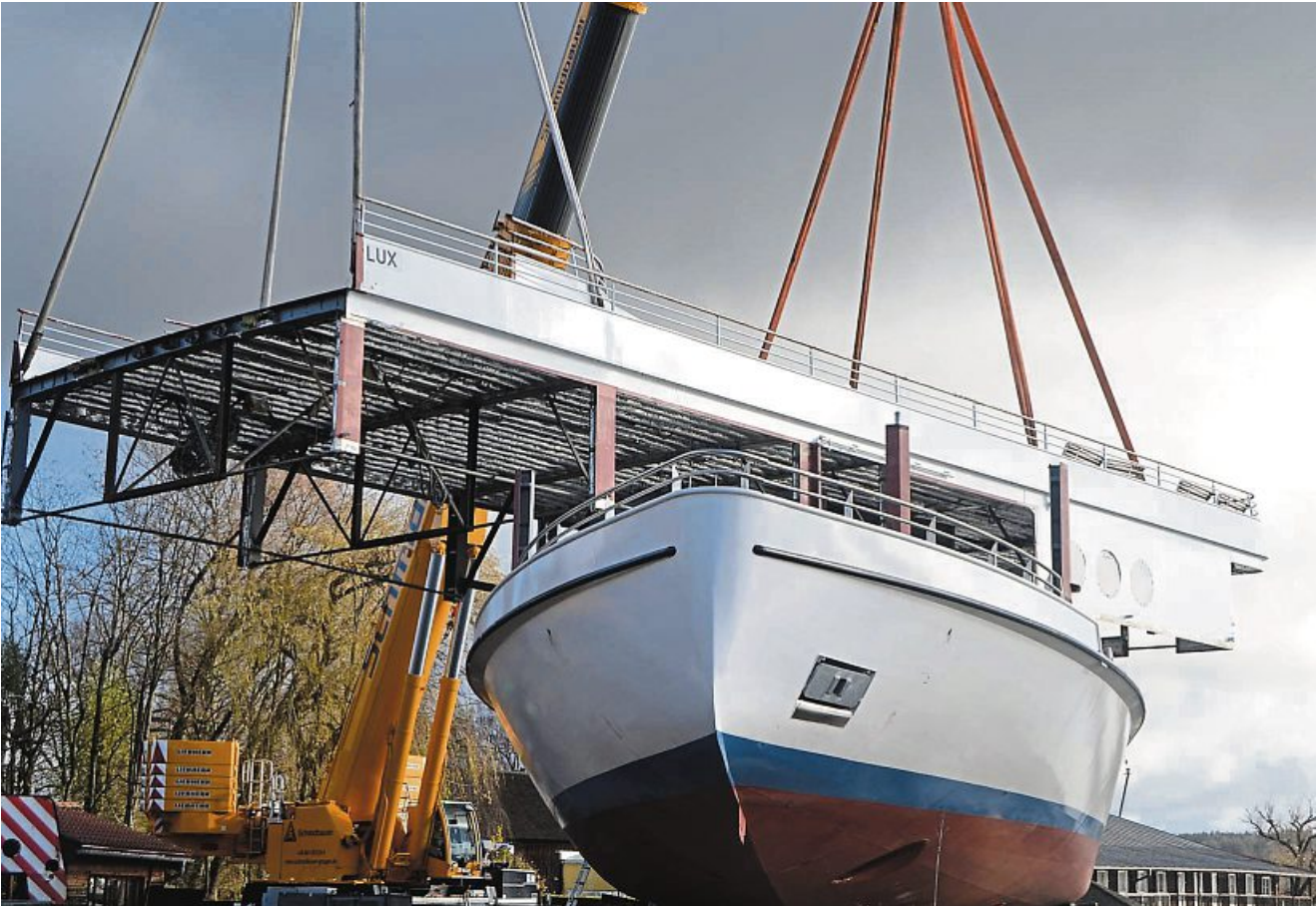
Gewissermaßen eine „Hochzeit“: Werden Bauteile zusammengesetzt, sprechen Techniker nicht selten von Hochzeit. Am Freitagvormittag setzten Arbeiter mit großen Autokränen das Oberdeck auf den Rumpf. Nun beginnen die Endmontage und der Innenausbau.
