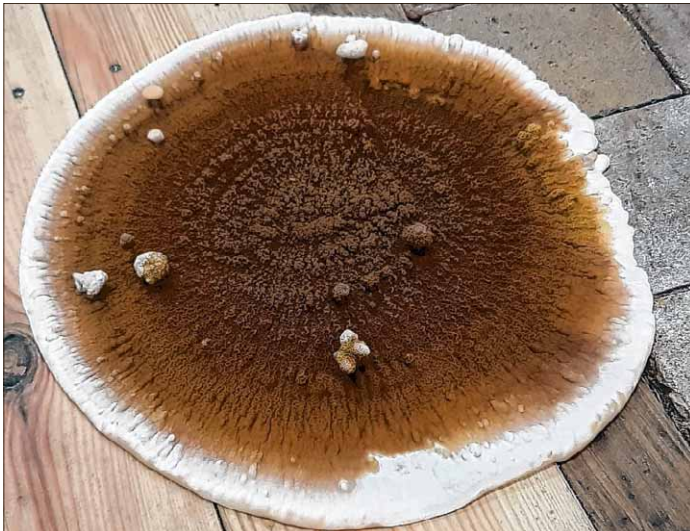
Der Hausschwamm in seinem klassischen tellerförmigen Aussehen: Innen braun und außen ein weißer Rand.
