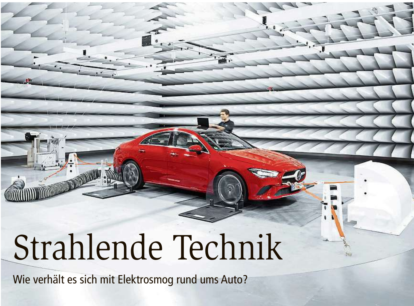
Keine Chance für schlechte Schwingungen: Um die Belastung der Autofahrer möglichst niedrig zu halten, unterhält Mercedes ein eigenes Testgebäude, um die Verträglichkeit elektromagnetischer Felder in seinen Autos zu prüfen. Foto: Daimler AG / dpa
