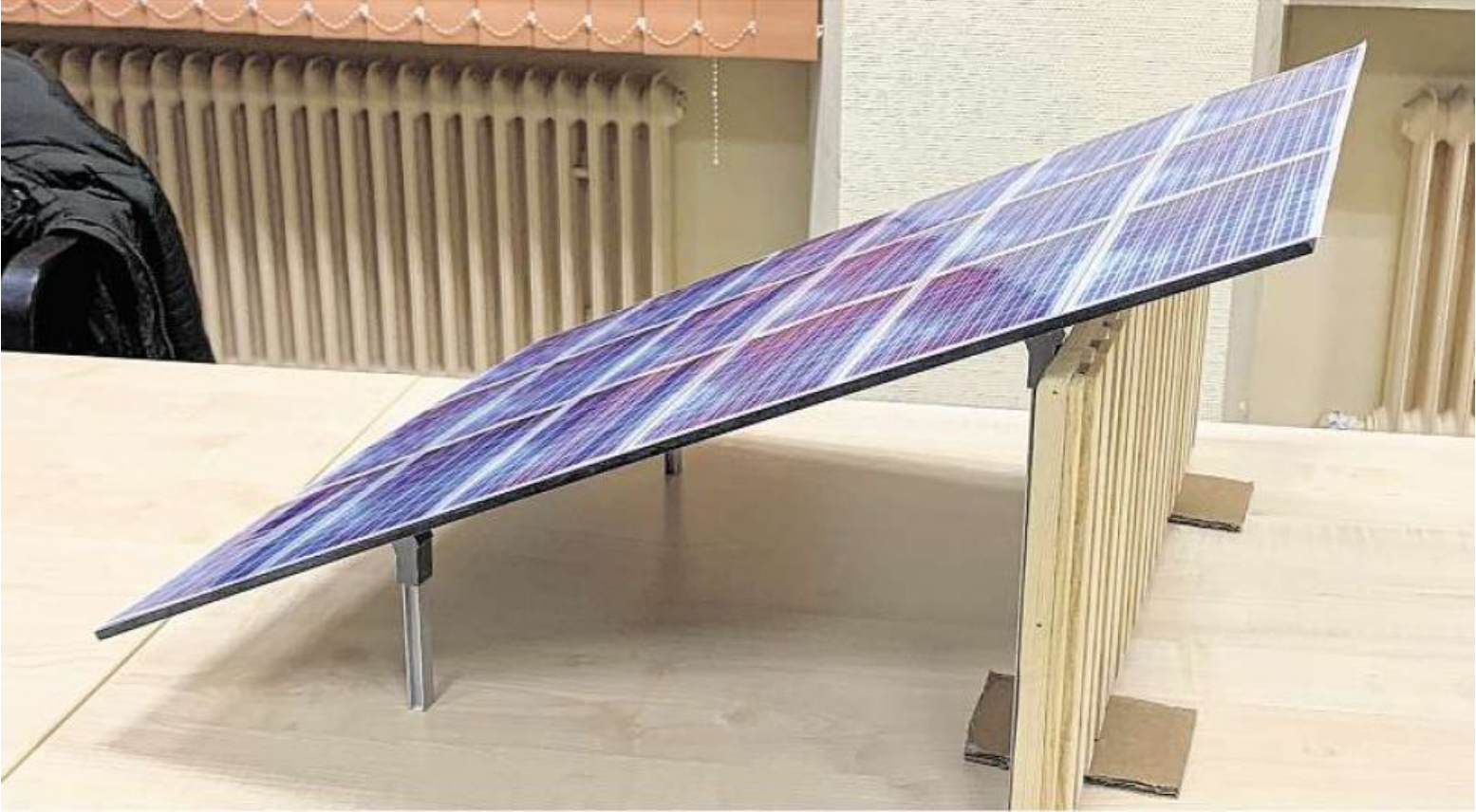
So sieht ein Solar-Modul im Modell aus, das einmal Teil einer Lärmschutzwand mit Energiegewinnung werden könnte.
