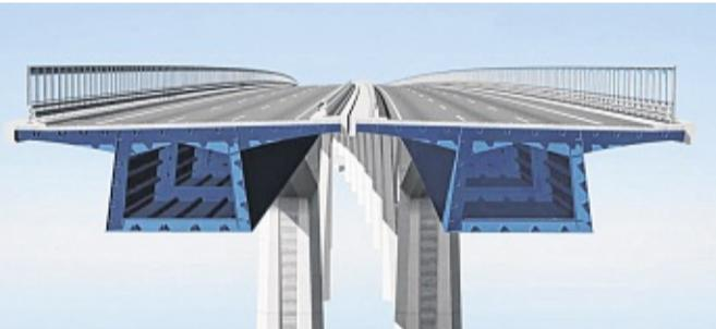
Die neue Rader Hochbrücke wird aus zwei einzelnen Brücken mit jeweils drei Fahrspuren bestehen.
