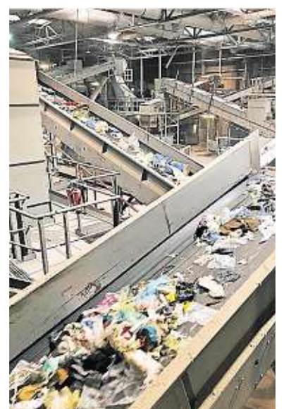
Nach der Siebtrommel sieht der Sperrmüll schon arg zerstückelt aus.
