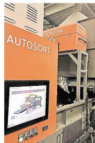
Der „Autosort“ erkennt Kunststoff und Papier, das er „ausbläst“.
