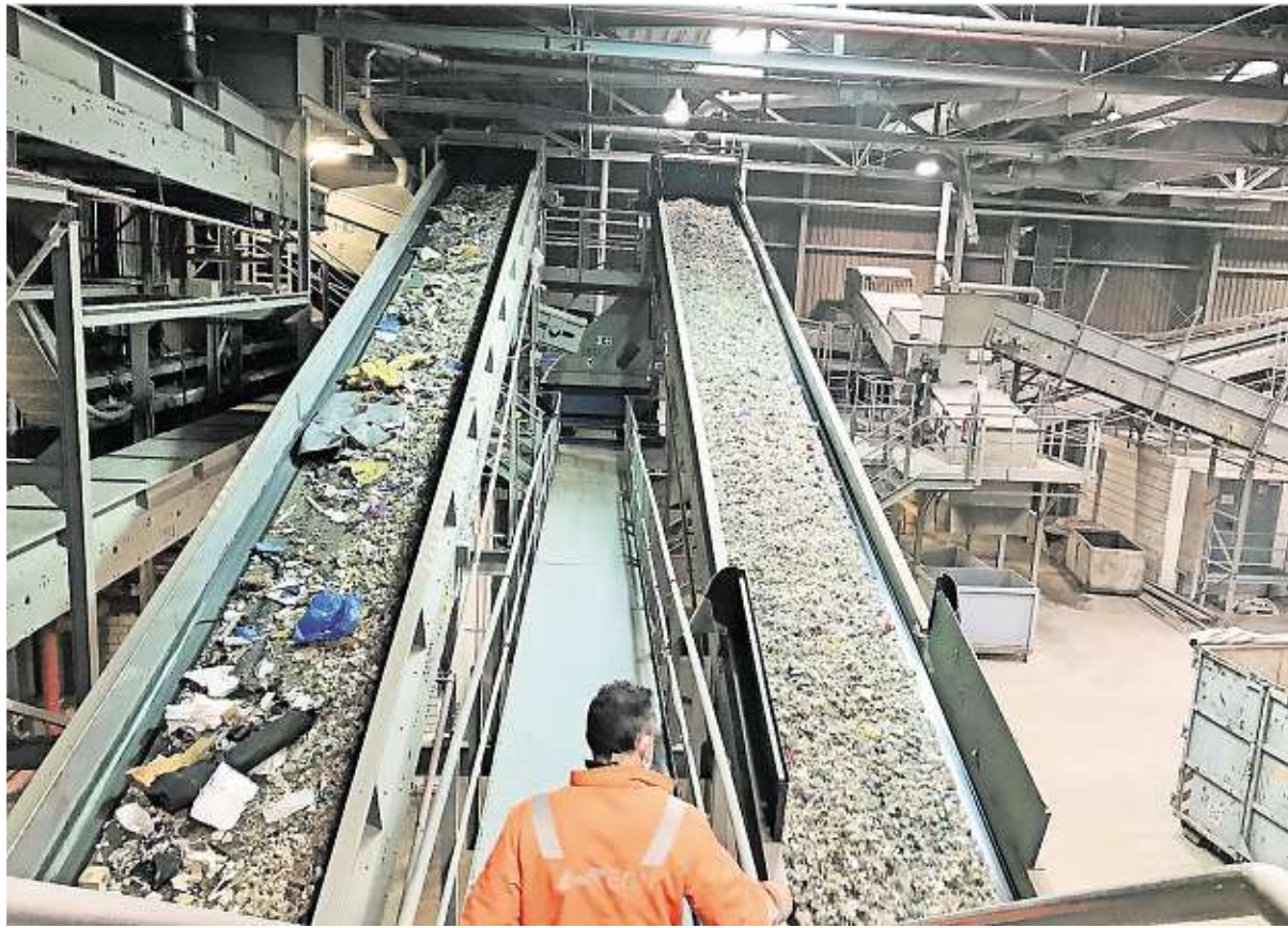
Auf langen Bändern fließt der nicht abreißende Ablaufstrom durch die Siebe und Sortieranlagen der Deponie. Das rechte Band ist schon die Schlussetappe des Brennstoffes, der in einer Extra-Halle gelagert wird.
