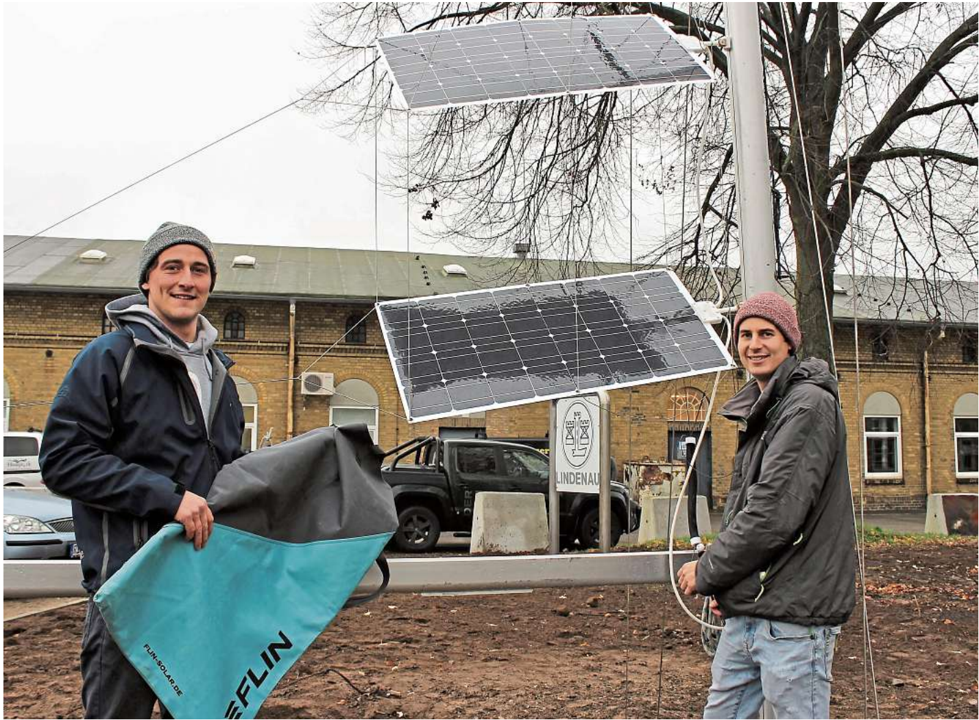
Allwetter-Test: Malte Nähtke (links) und Lasse Hochfeldt erproben auf dem Gelände der Lindenau-Werft Solarmodule, die Jachten mit Strom versorgen können.
