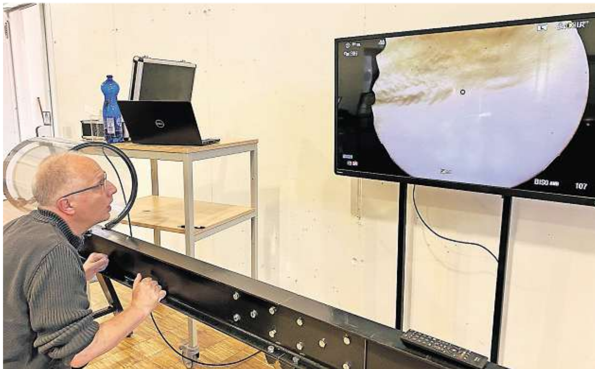
Georg Frangenberg demonstriert an dem Luftschlieren-Objekt wie der eigene Atem am Bildschirm sichtbar gemacht werden kann.
