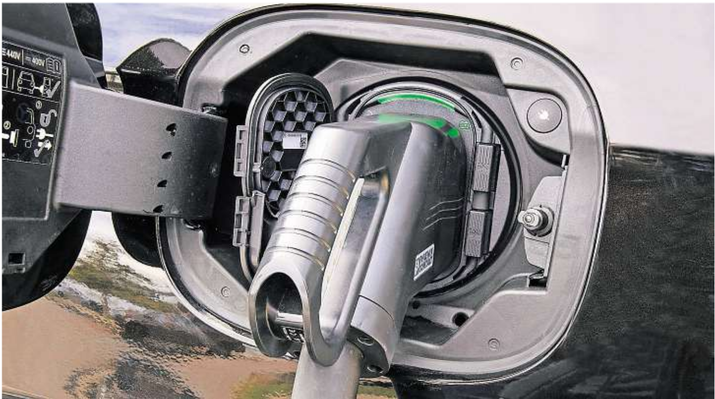
Der Akku, der in Plug-in-Hybriden den Elektromotor mit Energie versorgt, lässt sich auch an der Steckdose laden. Ein Verbrennungsmotor ist aber auch noch an Bord.
