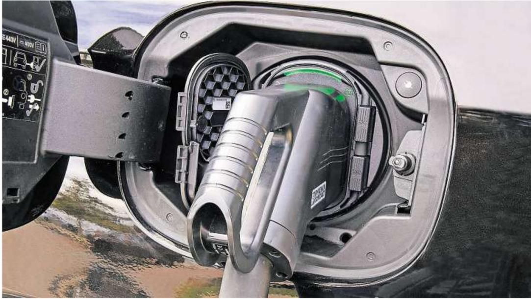
Der Akku, der in Plug-in-Hybriden den Elektromotor mit Energie versorgt, lässt sich auch an der Steckdose laden. Ein Verbrennungsmotor ist aber auch noch an Bord.
