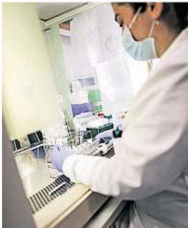
Nur unter einer Sicherheitswerkbank werden die Proben geöffnet.
