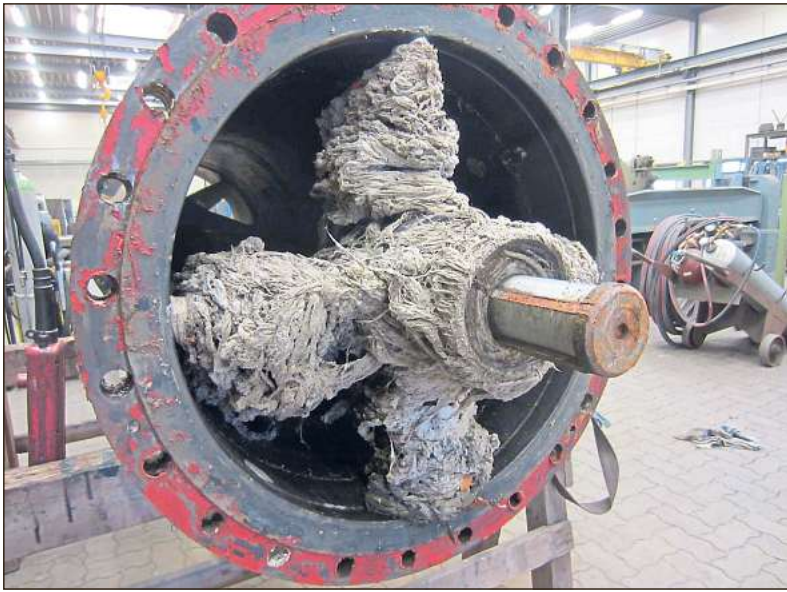
Völlig verfilzt: Die Feuchttücher werden in der Pumpe zum Ballast und beeinträchtigen die Funktion. Fotos (2): Abwasserbetrieb Warendorf
