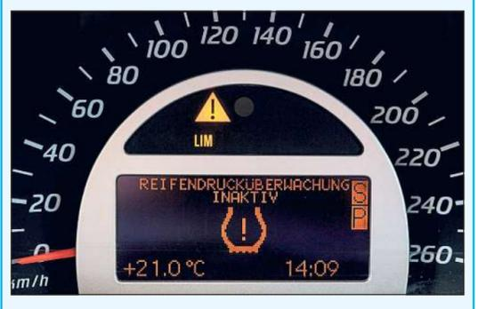
**Kein Kontrollverlust:** RDKS-Systeme überwachen den Reifendruck und warnen vor Gefahr. Foto: dpa
