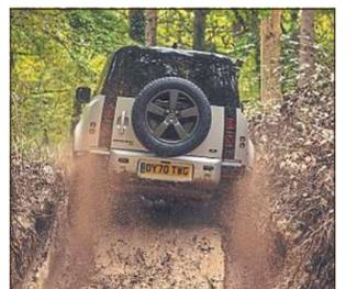
Bis zu 3,5 Tonnen darf der Defender 90 an den Haken nehmen. Der Kofferraum bietet zwischen 397 und 1563 Liter Ladevolumen.
