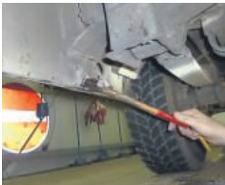
Diverse Rostlöcher waren nur einer von 64 Mängeln am Zustellfahrzeug. FOTO: POLIZEI
