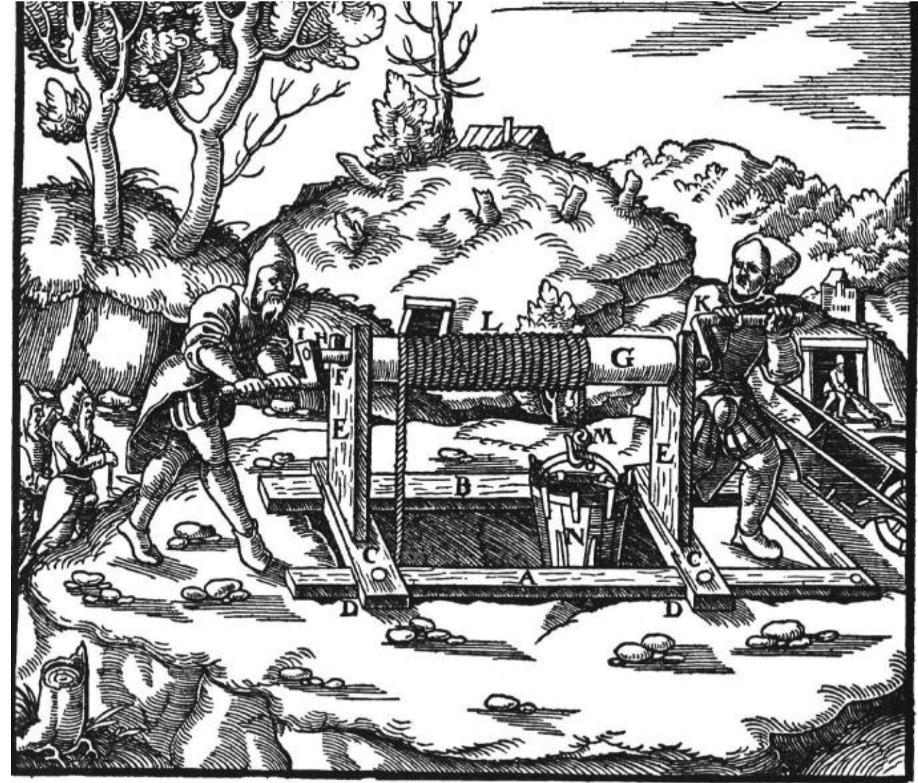
Der vorn am Schacht verlegte Pfühlbaum A. Der hinten am Schacht verlegte Pfühlbaum B. Die zugespitzten Pfähle C. Die Querhölzer D. Die Haspelstützen E. Die Pfadeisen F. Der Rundbaum G. Seine Zapfen H. Das Holz I. Die Kurbel K. Das Förderseil L. Der Seilhaken M. Das Fördergefäß N. Sein Bügel O.
