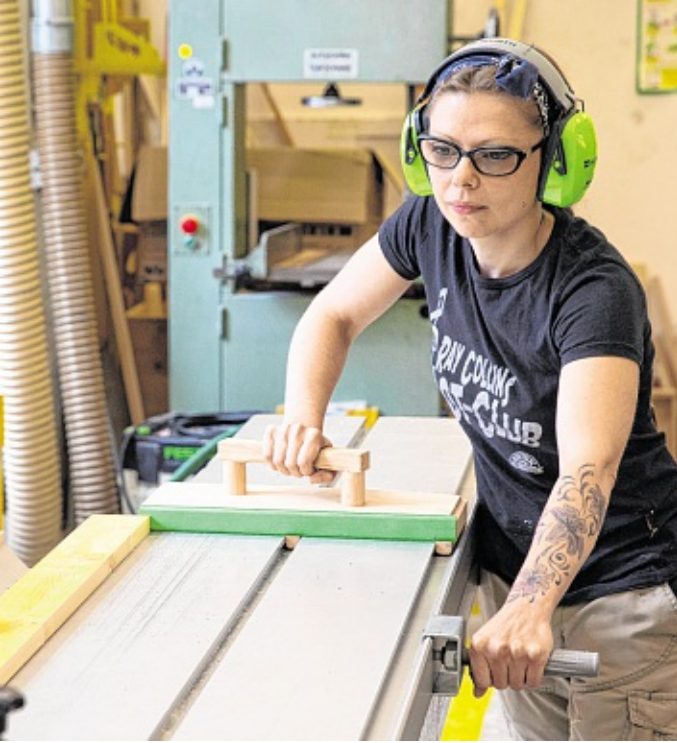
Der Umgang mit den Maschinen will gelernt sein, dafür machen Azubis verschiedene Maschinenscheine: Die angehende Tischlerin Marly Konefka nutzt hier die Tischkreissäge. FOTO: WAIBEL/DPA-TMN
