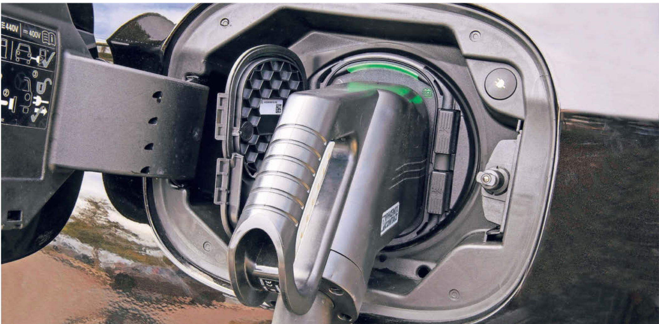
Der Akku, der in Plug-in-Hybriden den Elektromotor mit Energie versorgt, lässt sich auch an der Steckdose laden. Ein Verbrennungsmotor ist aber auch noch an Bord.
