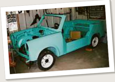
Der Trabi-Kübel „blank“, sprich: die nackte, gerade frisch mintgrün lackierte Karosserie.
