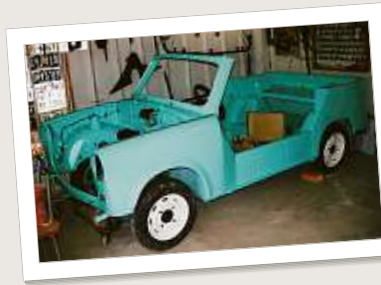
Der Trabi-Kübel „blank“, sprich: die nackte, gerade frisch mintgrün lackierte Karosserie.
