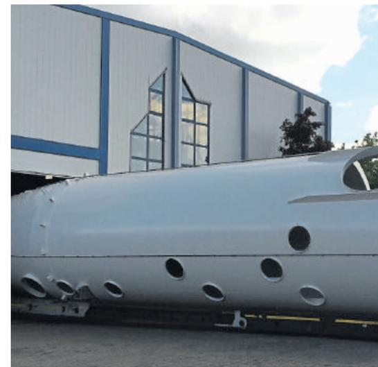
Bis zu 4 Meter Durchmesser haben die produzierten Stahlschornsteine.
