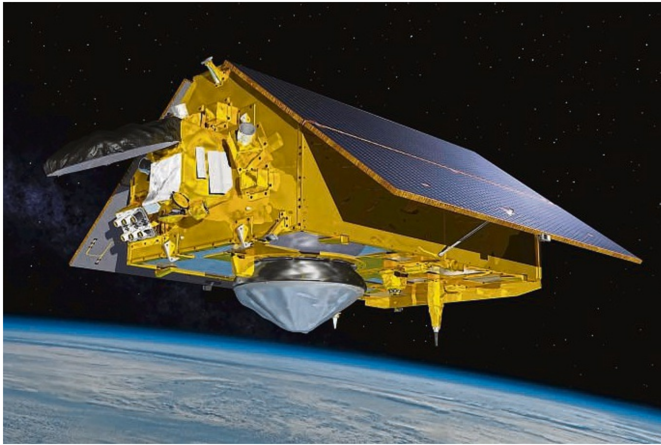
Unendliche Weiten: Der Erdbeobachtungssatellit Sentinel-6 schwebt mit ausgefahrenen Solarpaneelen im Orbit über der Erde (Illustration). Der Satellit scannt innerhalb von zehn Tagen 95 Prozent der globalen Meeresoberfläche – aus einer Höhe von mehr als 1300 Kilometern mit einer Genauigkeit von unter einem Millimeter.
