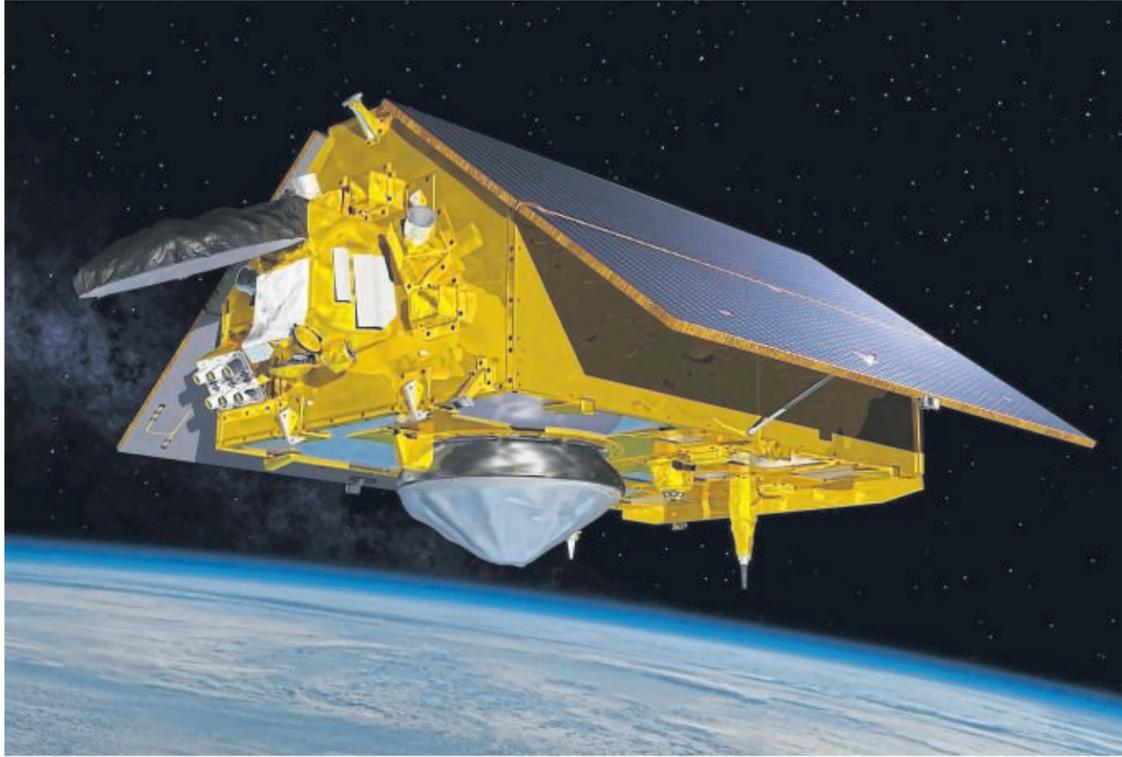
**Unendliche Weiten:** Der Erdbeobachtungssatellit Sentinel-6 schwebt mit ausgefahrenen Solarpaneelen im Orbit über der Erde (Illustration). Der Satellit scannt innerhalb von zehn Tagen 95 Prozent der globalen Meeresoberfläche – aus einer Höhe von mehr als 1300 Kilometern mit einer Genauigkeit von unter einem Millimeter. FOTO: NASA/DPA
