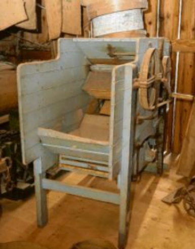
Mit der Windmühle wurde Saatgut von Unkrautsamen und Spreu gesäubert.
