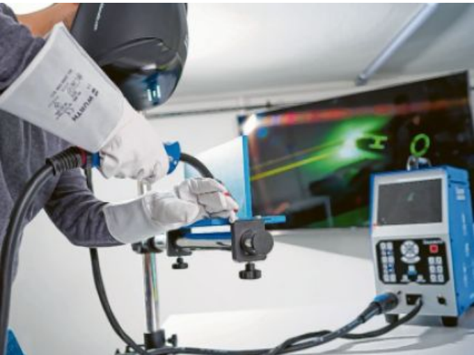
Ein innovativer 3D-Schweißsimulator ermöglicht virtuelles Schweißen von Schweißnähten.
