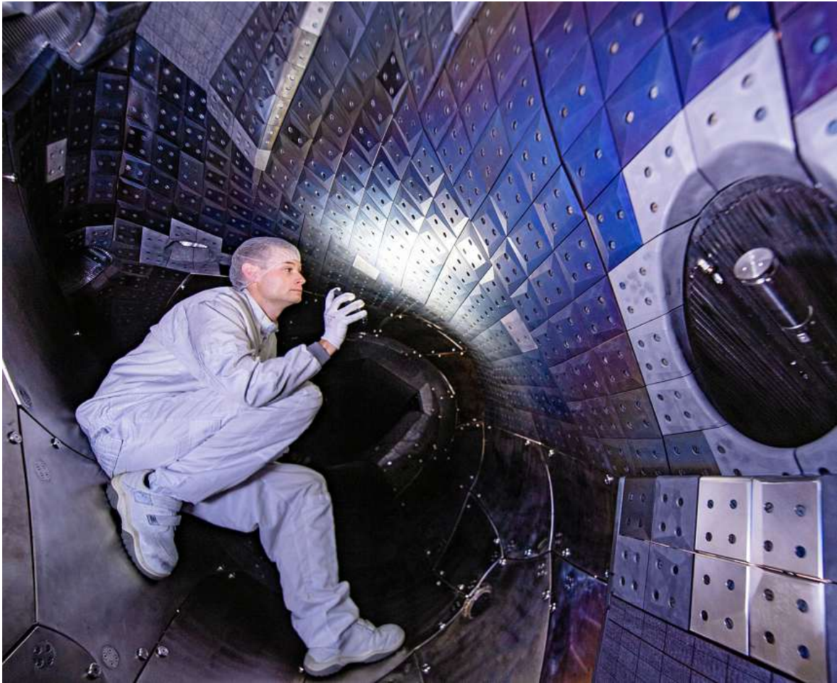
Blick auf Kohlestoff-Kacheln im ringförmigen Plasmagefäß des Forschungsreaktors.
