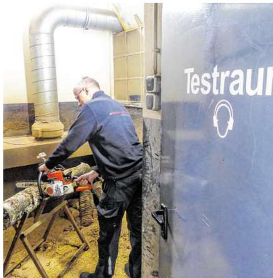
Die reparierten Kettensägen werden im Testraum auf ihre Funktionsfähigkeit überprüft.
