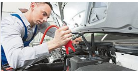
Die Autobatterie kann in der Werkstatt einfach auf Speicherkapazität, Ladezustand und die Kaltstromfähigkeit geprüft werden. Foto: ProMotor/T.Volz
