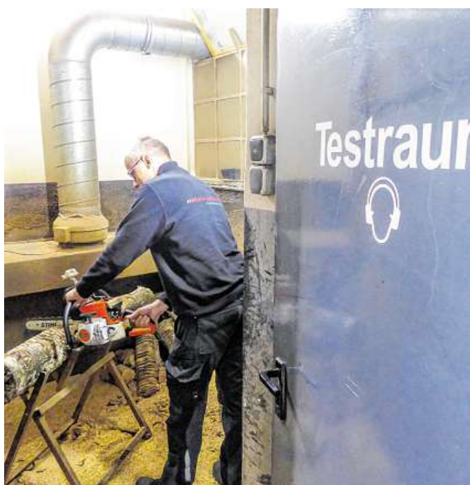
Die reparierten Kettensägen werden im Testraum auf ihre Funktionsfähigkeit überprüft.
