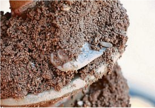
Mit mehreren verschiedenen Bohrköpfen wird der Boden bearbeitet. Sandiger Boden versetzt mit Steinen kam auf den ersten acht Metern zu Tage. Er wurde als Probe zur weiteren Untersuchung gesichert.
