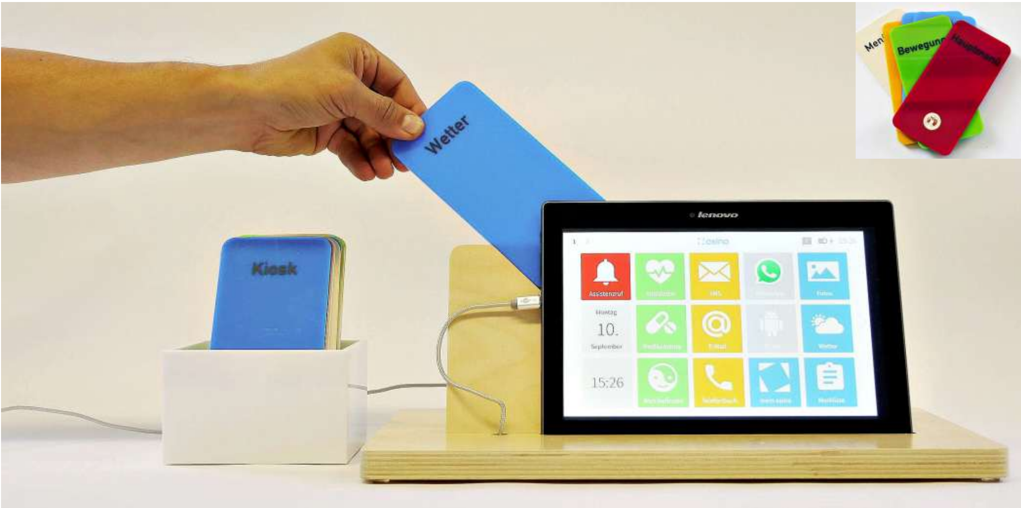
Die Bedienung des Tablets leicht gemacht: Wer eine „Smart Card“ an das Gerät hält, kann seine Wunsch-App abrufen. Die Karten sind groß, die Schrift ist gut lesbar (Foto rechts oben).
