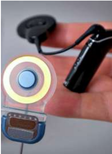
Cochlea-Implantat: links der Sensor, rechts der Audioprozessor mit Spule
