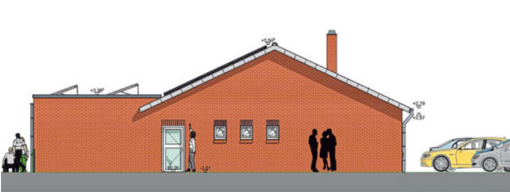
Ansicht von Osten: Die langgezogene Bestandsimmobilie aus dem Jahr 1996 mit einer Photovoltaikanlage auf einer Dachseite (Mitte) erhält an der zum Sportplatz von Germania Westerwiehe gelegenen Seite einen etwa 100 Quadratmeter großen Anbau (l.).
