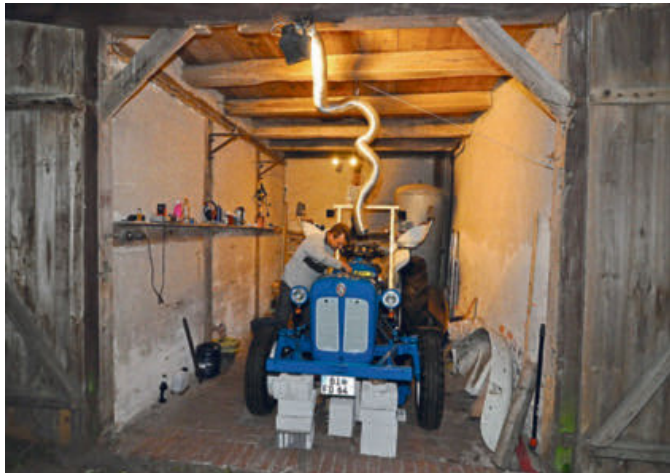
Ein flexibles Absaugrohr befördert die dunkle Abgaswolke, die beim Anlassen des Traktors entsteht, direkt aus der Scheune.
