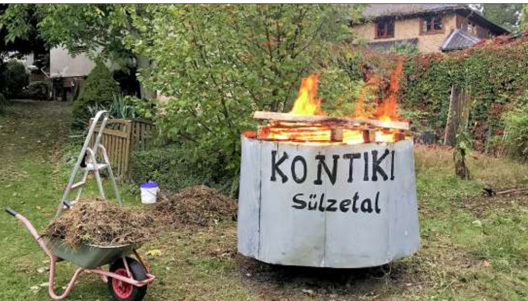
Im Kontiki-Ofen entsteht durch Verbrennung von Strauchschnitt, Kompost und Abfällen die Pflanzenkohle. Ein Schaubrennen findet in Langenweddingen statt. Foto: Jürgen Zimmermann
