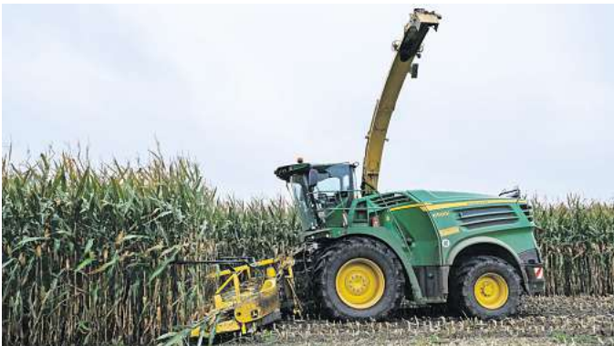
Silomais wird, anders als Kornmais, nicht mit einem Mähdescher, sondern mit einem Häcksler geerntet.
