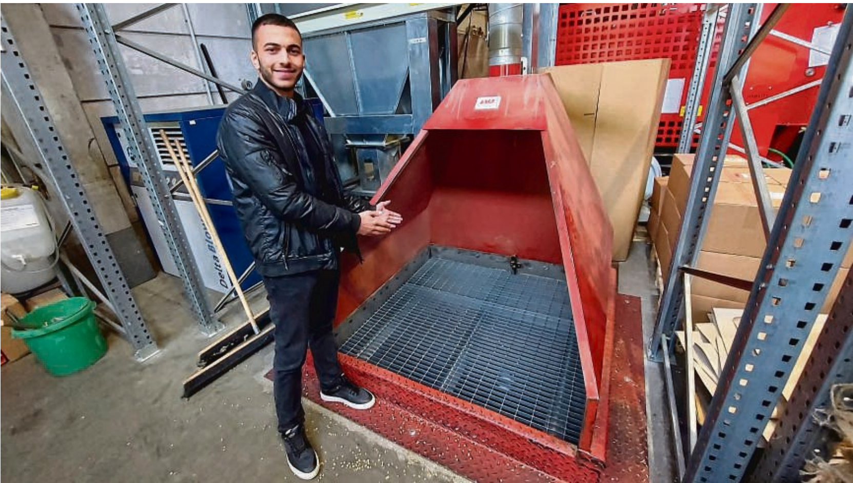
Tim Hühsam zeigt die Einfüllung zum Rohkaffeespeicher. Dort wird der Kaffee noch von kleinen Ästen und Steinchen befreit.
