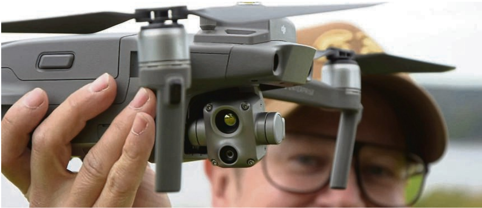
Drei Augen für die Wildtierrettung: Die Drohne ist mit einer visuellen sowie einer Wärmebild-Kamera und Sensoren bestückt.
