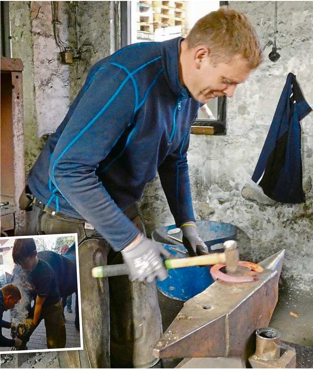
Lehrschmied Bernd Niehoff bringt auf dem Amboss in der Schmiede das glühende Eisen in Form, das anschließend an den Huf individuell angepasst wird (Foto links). Fotos: Marion Fenner
