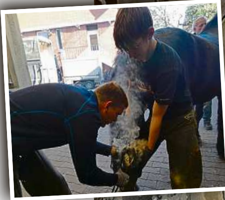
Lehrschmied Bernd Niehoff bringt auf dem Amboss in der Schmiede das glühende Eisen in Form, das anschließend an den Huf individuell angepasst wird (Foto links). Fotos: Marion Fenner
