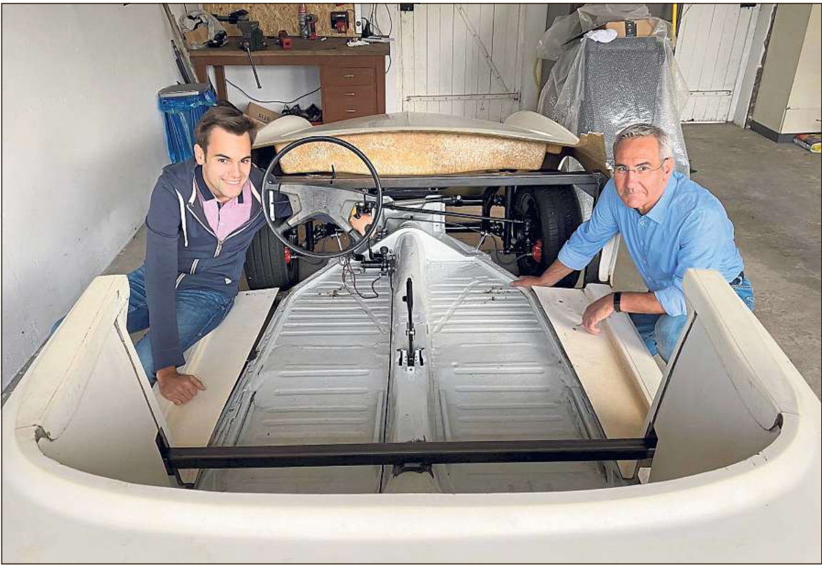
Einen individuellen VW Karmann-Ghia mit Elektromotor bauen Raúl Huesca Valverde und sein Vater Paco in Stromberg. Die Karosserie ist eine Karmann-Replica, das Chassis das eines VW Käfers von 1972.
