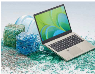
Das Gehäuse des Acer Aspire Vero besteht zu 30 Prozent aus recyceltem Kunststoff.
