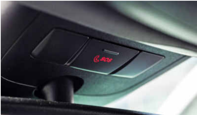
Hilfe auf Knopfdruck: Die Notruftaste für den E-Call findet sich entweder am Dachhimmel oder in der Mittelkonsole.
